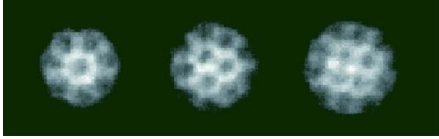
Figur 3: Vortices frastøder hinanden, og vil derfor danne et regulært gitter (Abrikosov lattice) i Bose-Einstein kondensatet. Figuren viser tæthedsfordelingen i kondensater med 7, 8 og 11 vortices [8].
