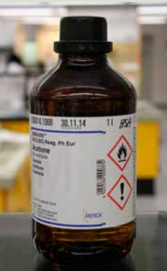
Acetone med kogepunkt 56 °C og flammepunkt -19 °C er "Flam.liq. 1". 1 liter svarer til 1 oplagsenhed
