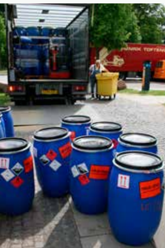
Forsendelse af kemikalieaffald. Godkendt yderemballage skal forsynes med transportmærkning
