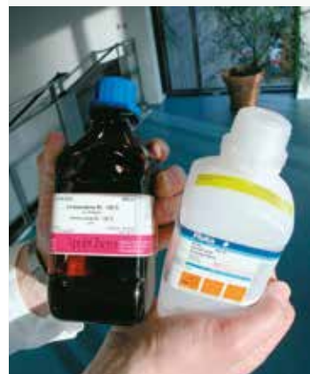
Koncentreret myresyre i glasflaske uden sikkerhedslåg (til venstre) kan eksplodere. Beholderen bør være af plast eller forsynet med sikkerhedslåg
