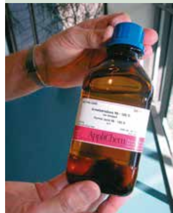
Koncentreret myresyre i glas-emballage uden sikkerheds-ventil
