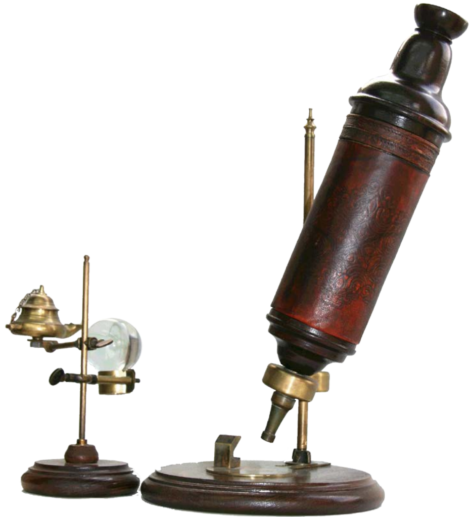
Robert Hookes sammensatte mikroskop. Designet af Hooke, fremstillet af Christopher Cock.
